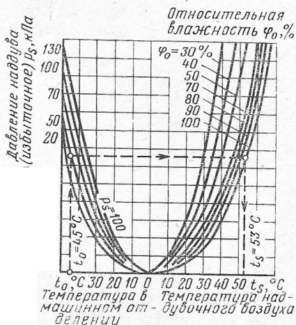
Рис. 7. График для определения температуры наддувочного воздуха в ресивере в зависимости от температуры и относительной влажности в машинном отделении
