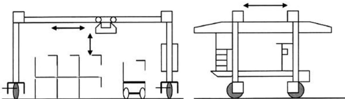
Рисунок 5 - Мостовой порталный контейнерный кран на пневмоходу
