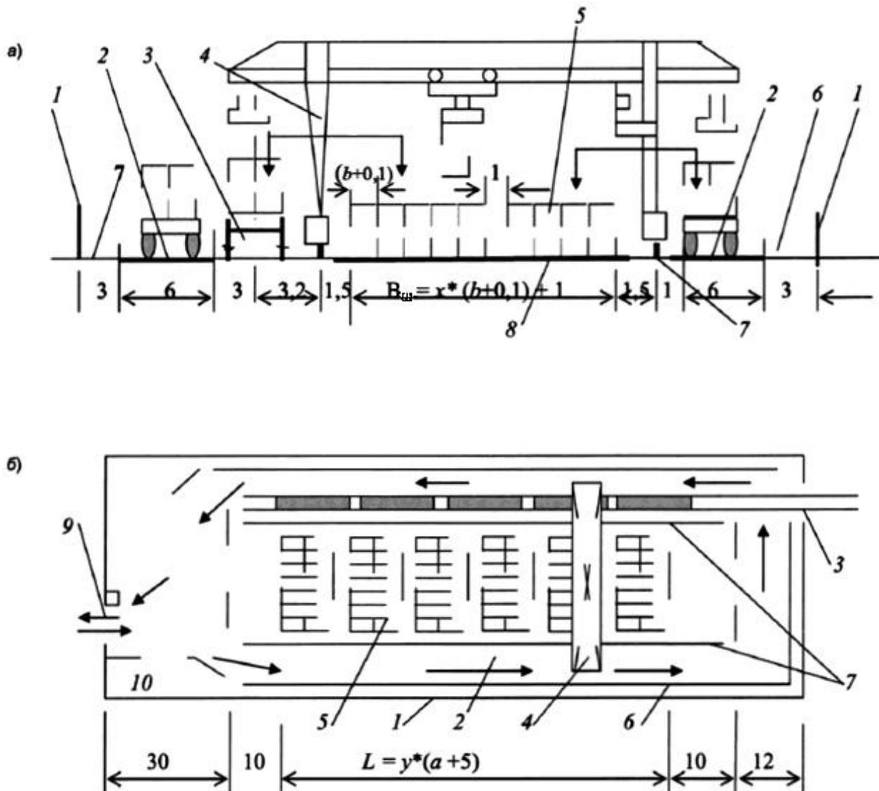
1 - ограждение терминала; 2 - автомобильные дороги; 3 - железнодорожный погрузочно-разгрузочный путь; 4 - козловой кран грузоподъемностью 6 т; 5 - штабели контейнеров; 6 - пешеходные тротуары; 7 - подкрановые пути; 8 - покрытие КП; 9 - ворота с контрольно-пропускным пунктом; 10 - ремонтная зона и автомобильная стоянка;  $x$  - количество контейнеров, расположенных на площадке;  $y$  - количество штабелей;  $a$  - длина контейнера;  $b$  - ширина контейнера (размеры, м)
