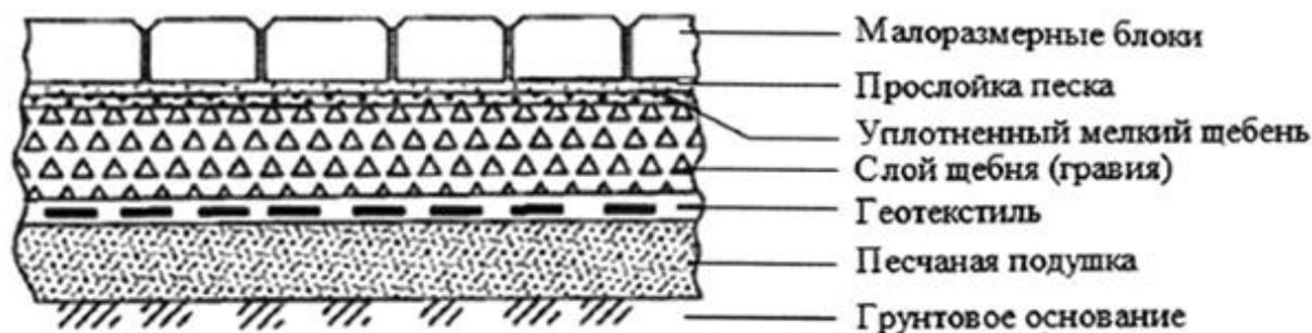
Рисунок 6 - Блочные покрытия
