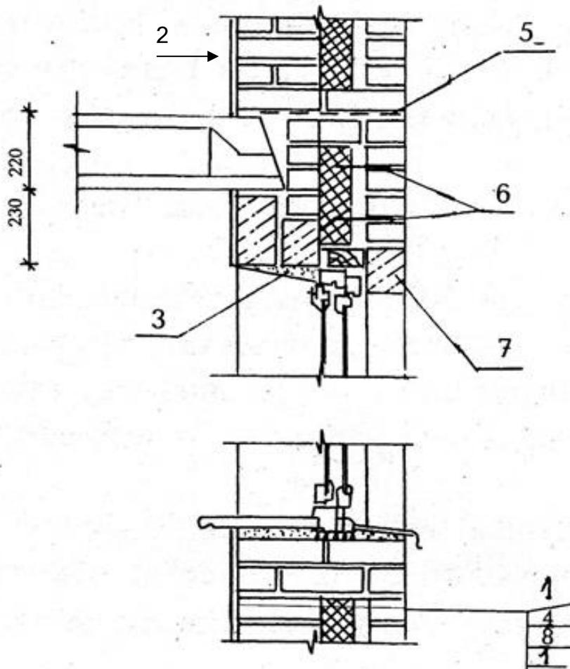
**Детали сечений стен кирпичной кладки:**
