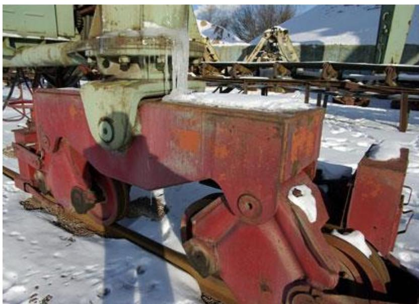
Пример ходовой тележки перегрузочного 10-и тонного крана
