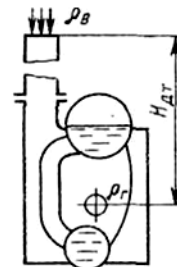
Рис.2. Схема котла с естественной тягой
