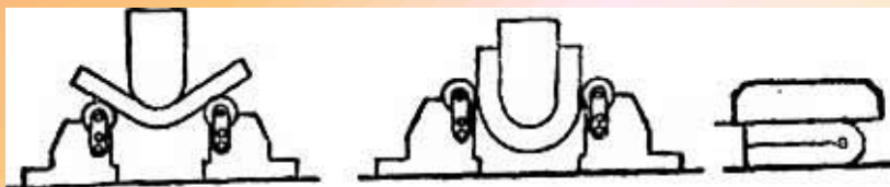
Рис. 29. Технологическая проба на загиб
