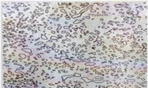
Структура стали после сфероидизирующего отжига
