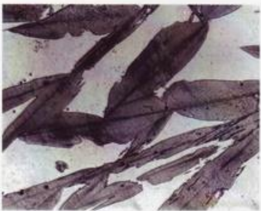
Пластинчатый (двойникованный) мартенсит
