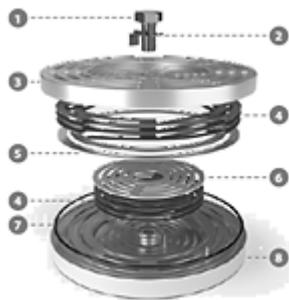
Рис. 3.11. Совмещенный всасывающе–нагнетательный концентрический клапан с пластинчатыми пружинами: 1 — центральный болт; 2 — стопорная шайба; 3 — седло всасывания; 4 — рессорные листы (пластинчатые пружины); 5 — плита/кольцо нагнетательного клапана; 6 — плита всасывающего клапана; 7 — кольцевое уплотнение; 8 — седло нагнетания
