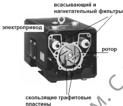
Рис. 6.8. Пластинчатый компрессор DLT40 фирмы Hamworthy
