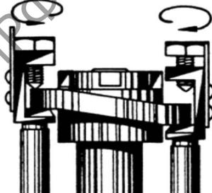
Рис. 3.5. Регулировка подачи насоса цилиндрической смазки Hatlapa W
