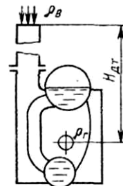
Рис. 3.4. Схема котла с естественной тягой
