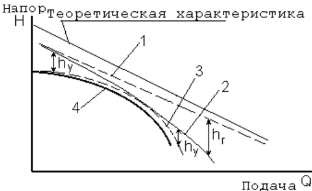
Рис. 17. Отклонение фактической характеристики центробежного насоса от теоретической:
