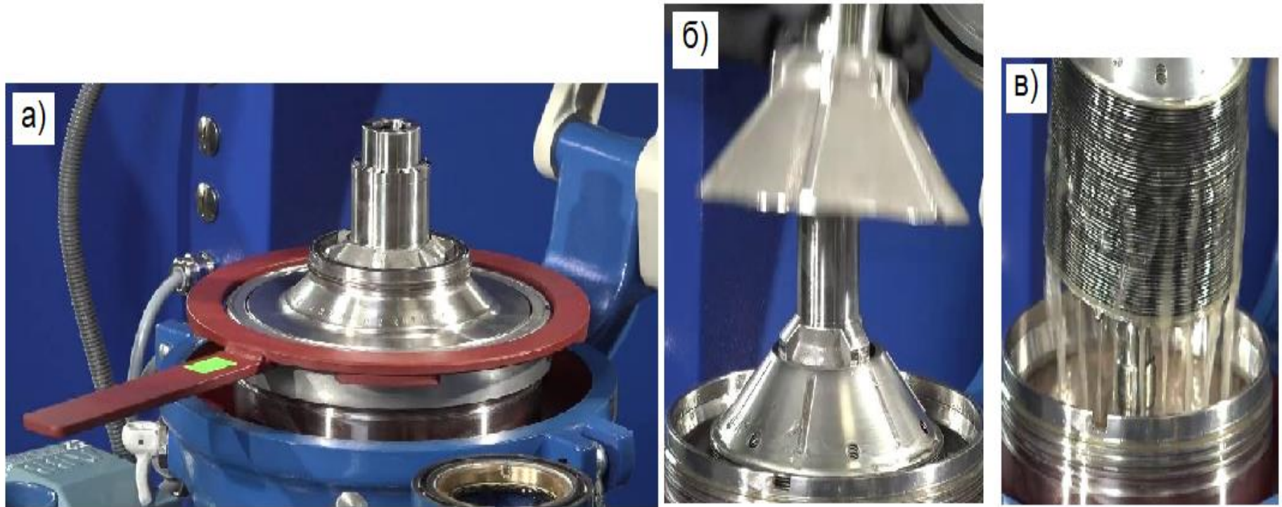
Рис. а) - ключ для демонтажа большого стопорного кольца крышки барабана, б) – демонтаж верхнего диска и в) -демонтаж тарелкодержателя с комплектом тарелок
