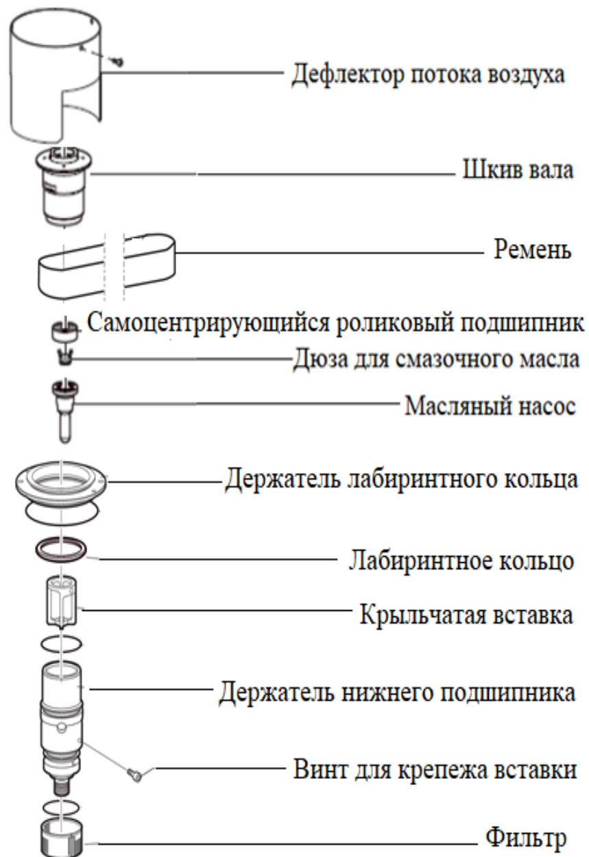
Рис. Основные детали устройства опоры и привода вертикального вала.
