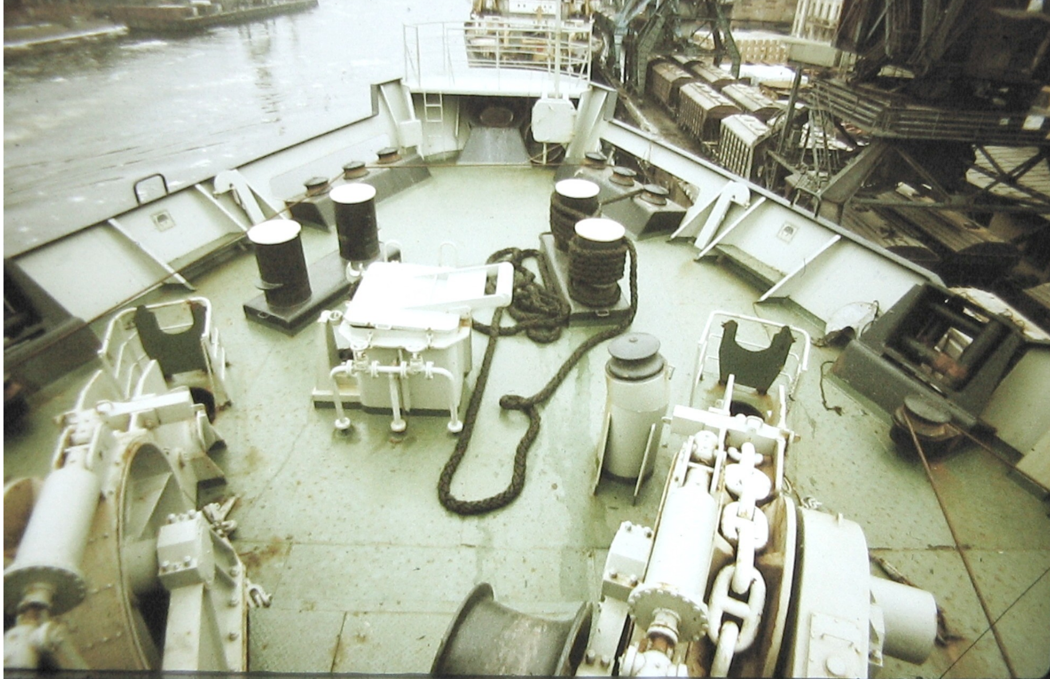
Швартовное и якорное устройства
