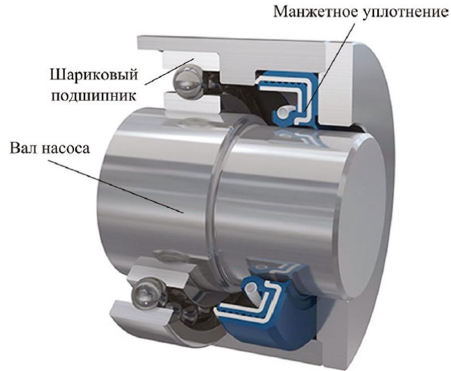
Рис. 31. Устройство манжетного уплотнения центробежного насоса
