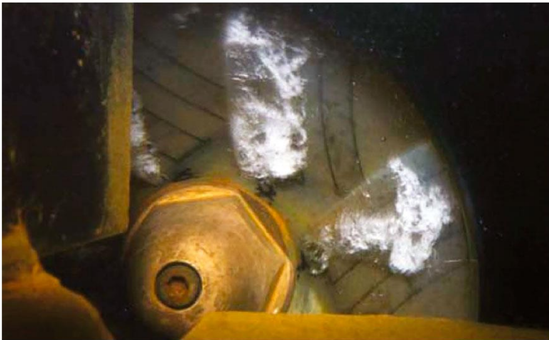
Рис. 38. Кавитация (вскипание перекачиваемой жидкой среды) на входе в рабочее колесо насоса
