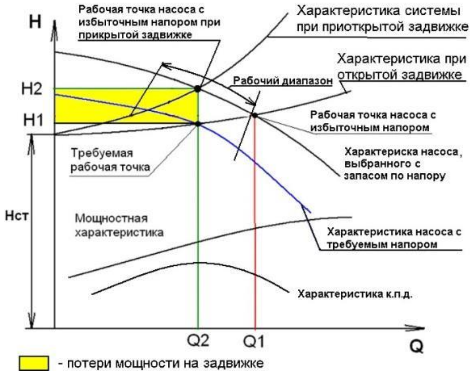
ис. 2. Характеристики насосов с требуемым и избыточным напором.
