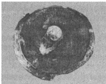
Рис. 11.8. Обрыв тарелки клапана под действием ударов
