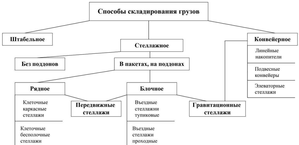
Рис. 5 Классификация способов складирования тарно-штучных грузов
