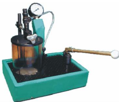
Рис.1. Стенд для опрессовки форсунок: 1- насос высокого давления 2 - рычагом, 3 - манометр, 4 - бачок с топливом, 5 - крана подачи топлива 6 - испытываемая форсунка, и 7 - поддон.
