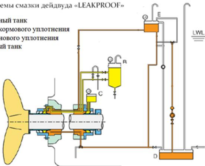
Рис. 4. Схема масляной системы
