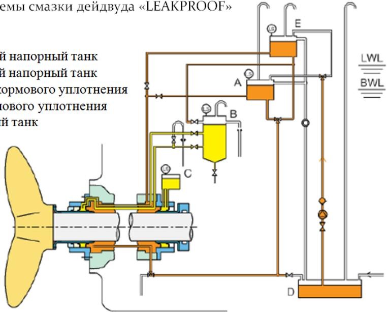
Для смазки дейдвудных подшипников и обеспечения постоянного давления масла в дейдвудной трубе масляную цистерну устанавливают на высоте 0,3-0,5 м выше уровня забортной воды при максимальной осадке судна.
