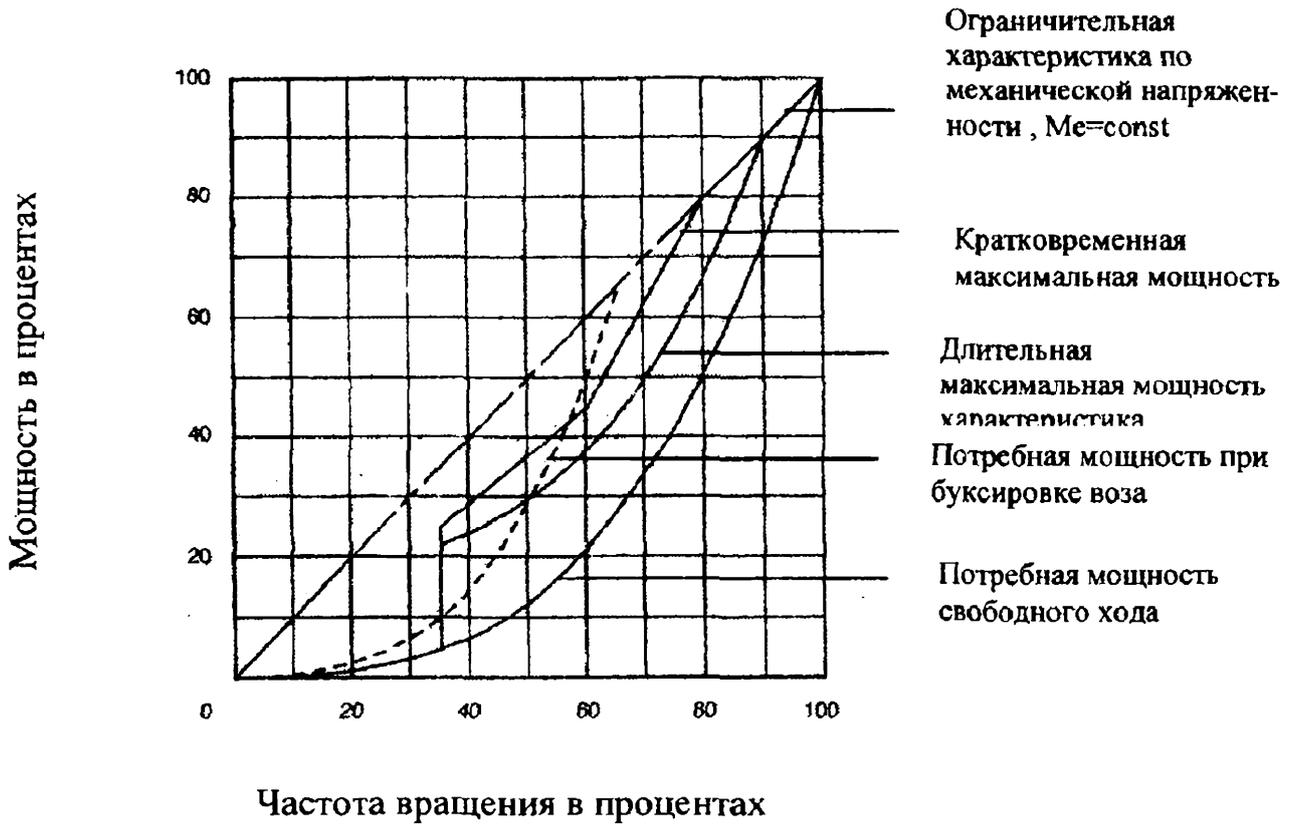
Рис. 1. Зависимость мощности от частоты вращения ВФШ
