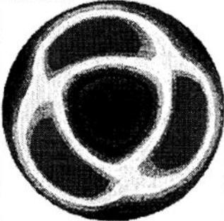
Рис.3 Интенсивность теплового потока на поршне для К90МС-С с двумя и тремя форсунками
