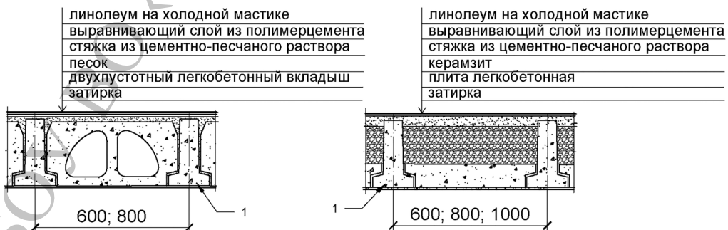
Рис. 4. Варианты заполнения перекрытия между железобетонными балками:
