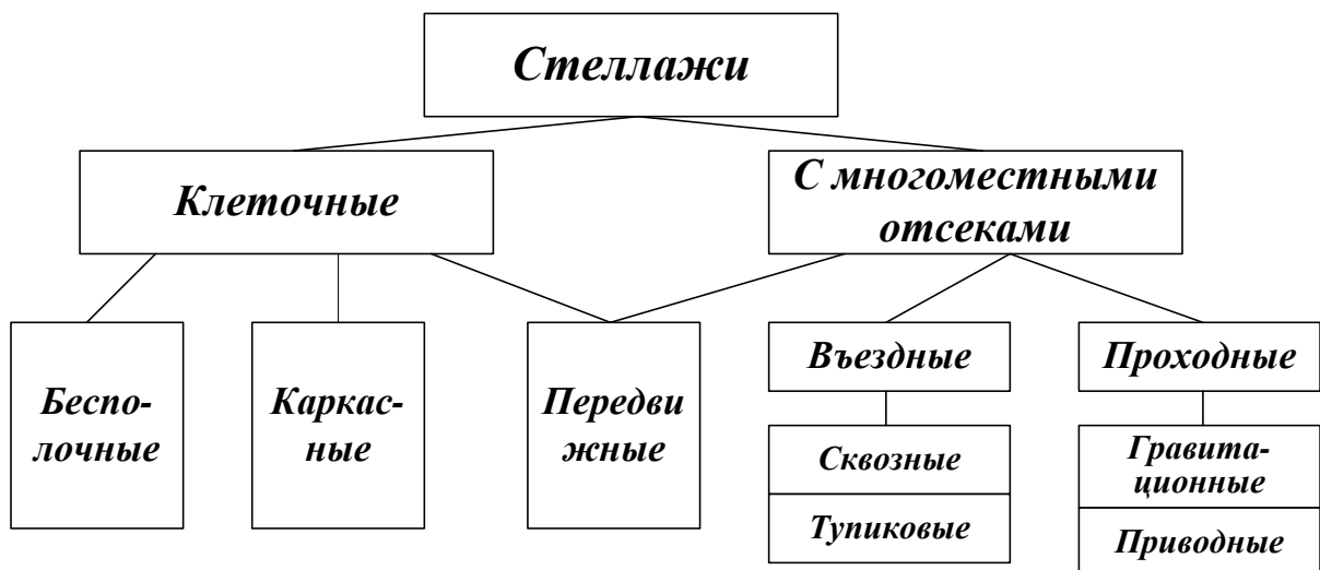
Рис. 7 Классификация конструкций стеллажей для пакетированных тарноштучных грузов
