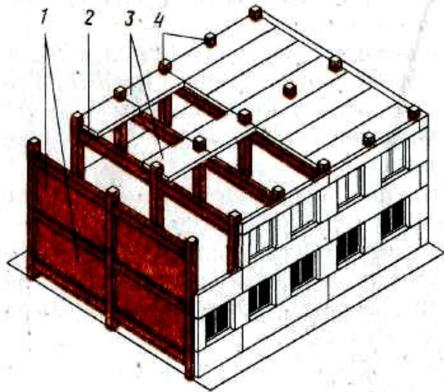
37. ЭЛЕМЕНТЫ, ОБЕСПЕЧИВАЮЩИЕ ПРОСТРАНСТВЕННУЮ ЖЕСТКОСТЬ КАРКАСНЫХ ЗДАНИЙ
