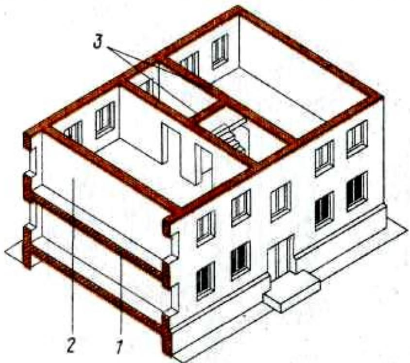
36. ЭЛЕМЕНТЫ, ОБЕСПЕЧИВАЮЩИЕ ПРОСТРАНСТВЕННУЮ ЖЕСТКОСТЬ БЕСКАРКАСНЫХ ЗДАНИЙ
