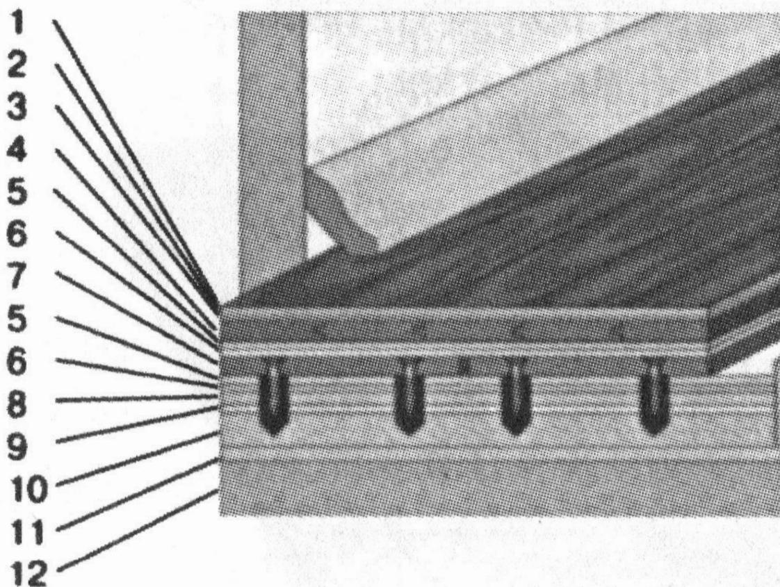
Схема конструктивного решения пола с покрытием из штучного паркета, разработанная фирмой «Паркет Холл» на бетонном перекрытии (со стяжкой)
