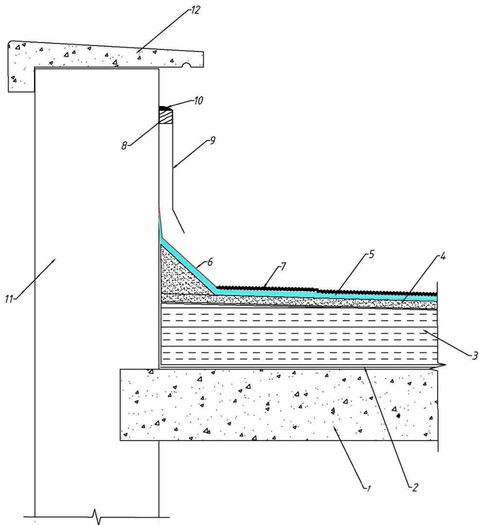
1- железобетонная плита покрытия; 2- пароизоляция (один слой рубероида);
