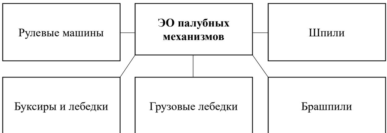
Схема 4. Схема состава ЭО палубных механизмов
