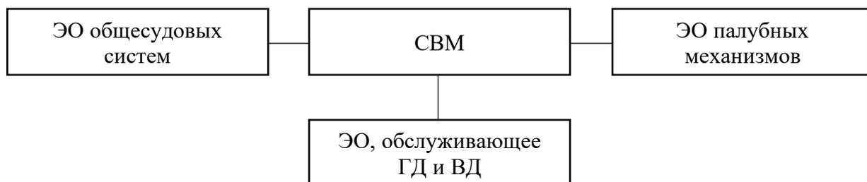
Схема 1. Схема состава вспомогательных механизмов
