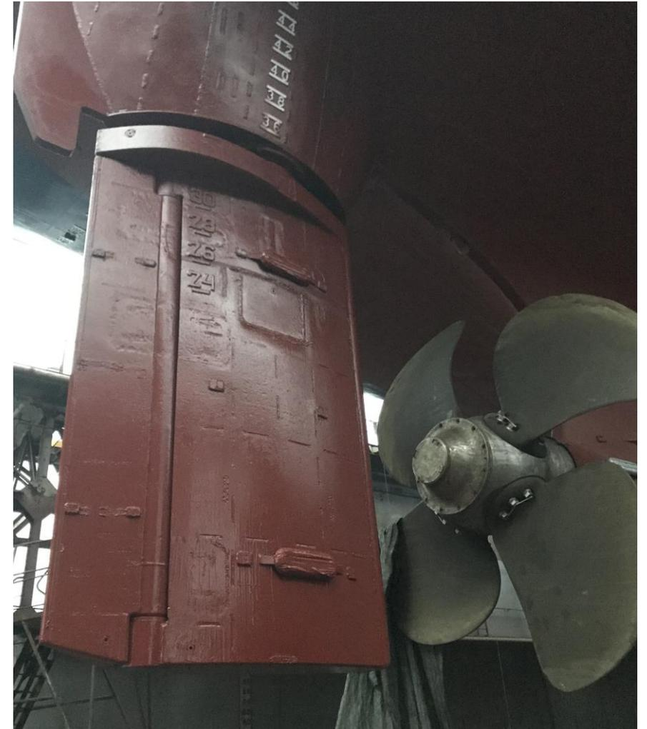
Поворотные насадки представляют собой направляющую насадку гребного винта, укрепленную на вертикальном баллере, ось которого пересекается с осью гребного винта в плоскости диска винта (рис.). Поворотная направляющая насадка является частью движительного комплекса и одновременно служит органом управления, заменяя руль. Выведенная из ДП насадка работает как кольцевое крыло, на котором возникает боковая подъемная сила, вызывающая поворот судна.
