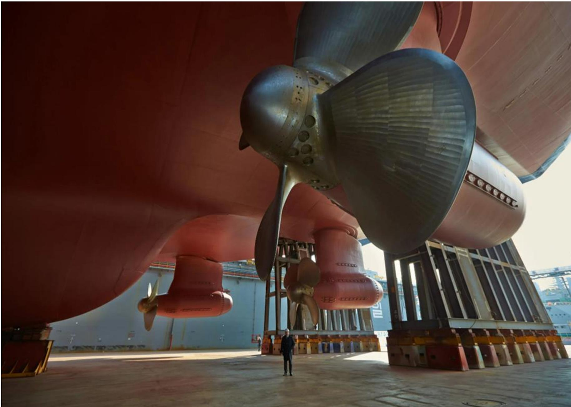
*Три аzipода с винтами меньшего диаметра уменьшают пустующий объём кормы над винтами и повышают надёжность ГЭУ в случае отказа одного аzipода, так как теряется только 33% тяги ( вместо потери 50% при отказе одного из двух аzipодов). Также изготавливать и эксплуатировать дешевле менее крупные агрегаты в больших количествах.*
