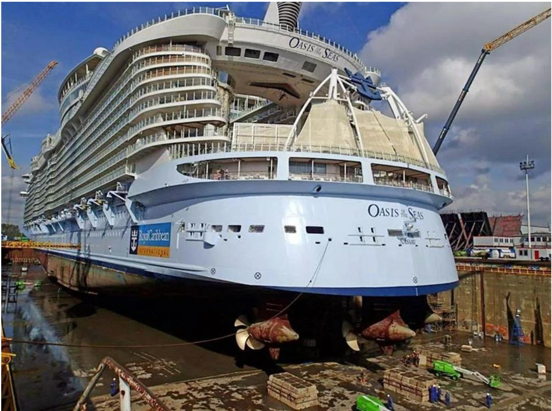
Установка двух-трёх независимо поворачивающихся азиподов сзади судна позволяет добиться сверхманевренности судна в порту, особенно при наличии поперечных винтов в носу судна.
