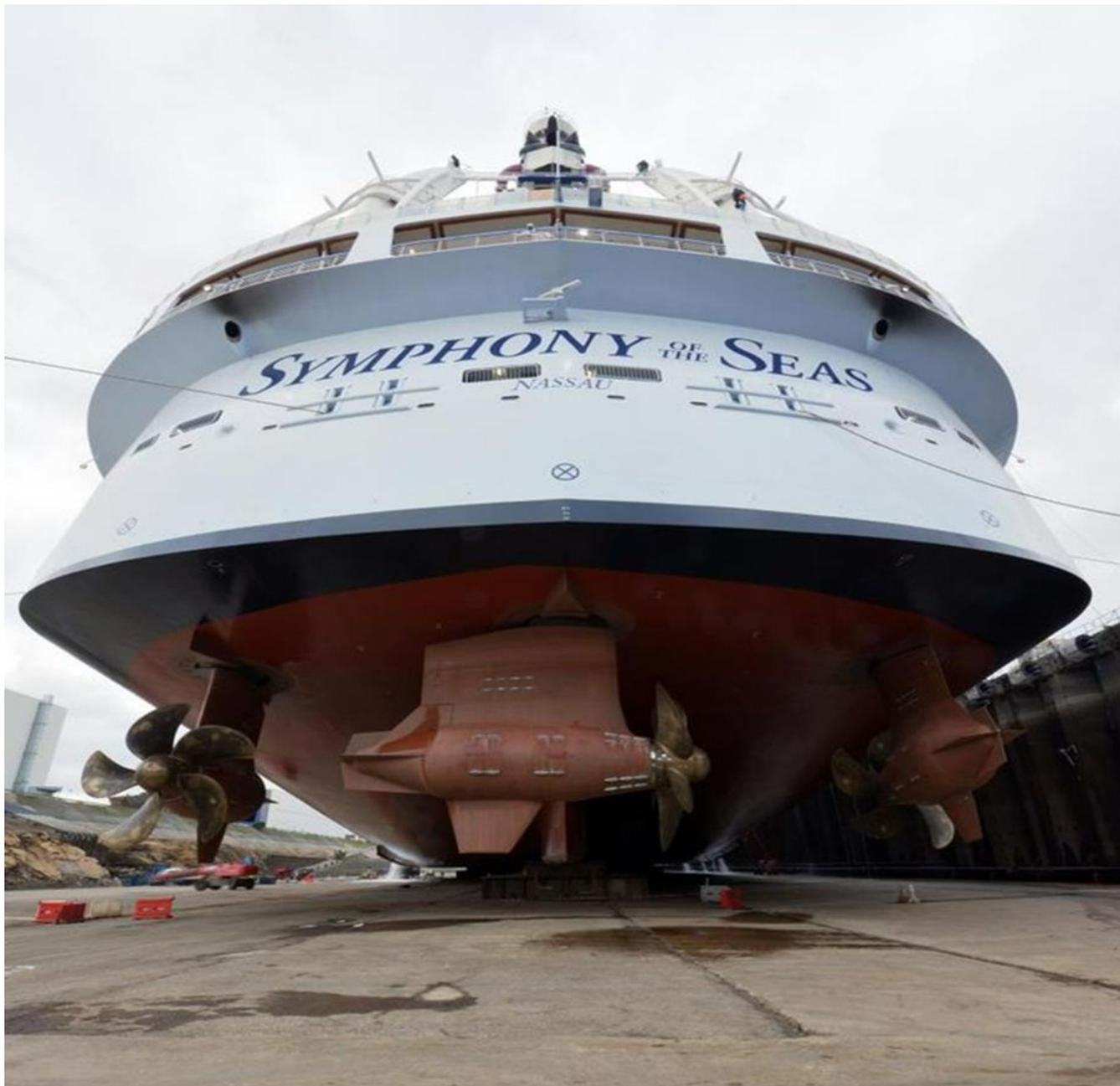
*Вид на корму лайнера типа «Оазис». В качестве главных винтов установлены три Азипода мощностью по 20 МВт каждый, которые способны разогнать лайнер до 22 узлов (40км/ч). Осадка мегалайнеров серии «Оазис» составляет всего 9 метров, при ширине корпуса 47 м по ватерлинии. Круизные лайнеры- это широкие плоскодонки, в сравнении с осадкой 15м у танкеров Афрамекс при ширине в 42 м.*
