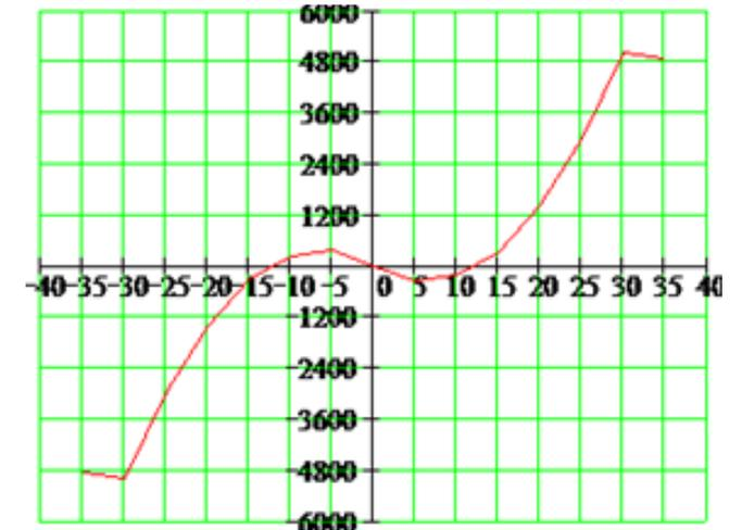
Характеристики момента на баллере руля: 1) некомпенсированный (простой) руль; 2) компенсированный (балансирный и полубалансирный) руль; 3) перекомпенсированный
