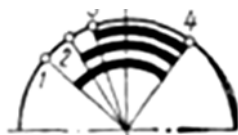
Рис.5. Диаграмма подачи топлива при регулировке по началу подачи.
